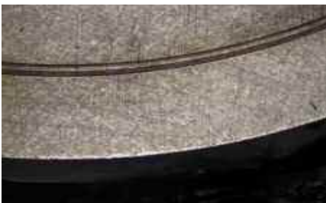
Einlaufrille nach 24 Stunden Run-in groove after 24 hours
